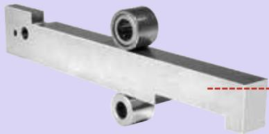
Стабильный, прямоугольный ходовой маятник Из прочной, специальной стали, по направлению нагрузки точно посажен на игольчатые подшипники, которые направляют маятник с обеих сторон по всей длине хода, для ровного прямоугольного без сколов реза даже при жесткой эксплуатации с многократно усиленным давлением на пильное полотно, например, при использовании бугеля. Для сверхдолгого срока службы.
