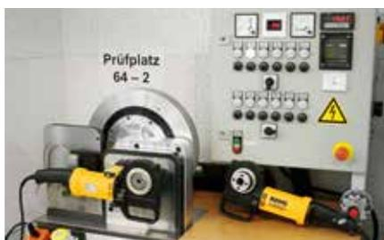
Частые проверки во время процесса изготовления и детальная проверка рабочих функций и безопасности после сборки гарантируют, что ни одно бракованное изделие не покинет предприятие.
