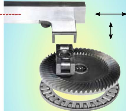
Сверхпрочный водо- и пыленепроницаемый, не требующий обслуживания эксцентриковый привод для одновременного прямого и орбитального хода штока и полотна пилы. Кривошипно-шатунный механизм с игольчатыми подшипниками (ANC) снижает трение, нагревание, износ. За счет этого обеспечивается длительный срок эксплуатации привода, даже при экстремально высоких нагрузках при пилении.
