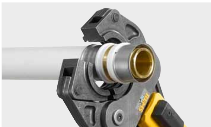
Пресс-клещи REMS (PR-3B) с 3 «плавающими» пресс контурами для обжима фитингов больших размеров, к которым предъявляются особые требования. Оптимальный обжим благодаря радиально направляемому движению «плавающих» пресс контуров, с промежуточной фиксацией.
