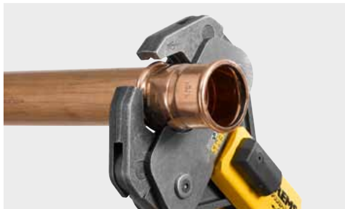
Пресс-клещи REMS (4G) с 2 параллельно расположенными пресс-сегментами на шарнирах для прямого прессования средних диаметров.
