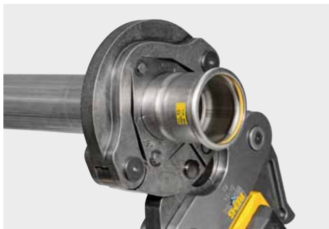
Пресс-шайба REMS (PR) с 3 запрессовочными сегментами, установленными на поворотном шарнирном кольце, для осуществления запрессовок больших размеров, к которым предъявляются особые требования. Оптимальное прессование обеспечивается радиально управляемым движением пресс-сегментов, с промежуточными клещами.
