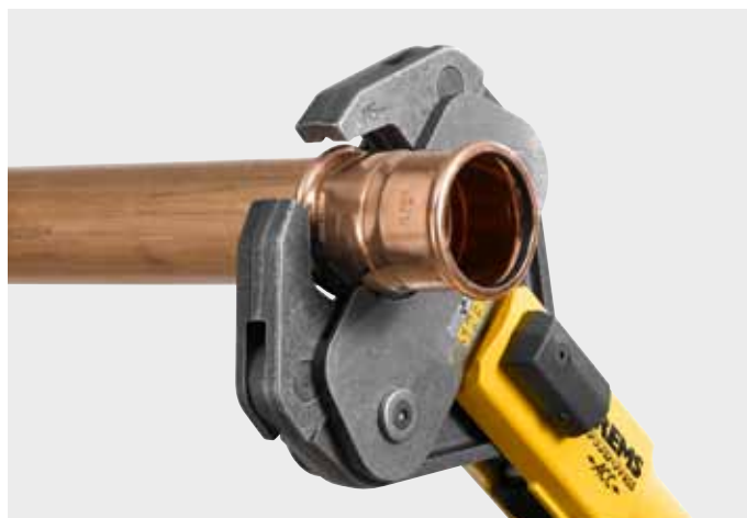
Пресс-клещи REMS (4G) с 2 параллельно расположенными пресс-сегментами на шарнирах для прямого прессования средних диаметров.
