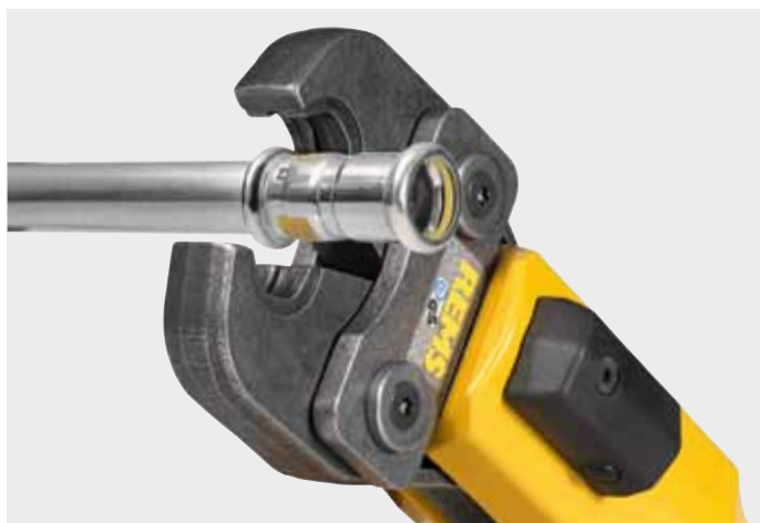
Пресс-клещи REMS с двумя вращающимися однокорпусными пресс-колодками. Самая популярная стандартная конструкция.
